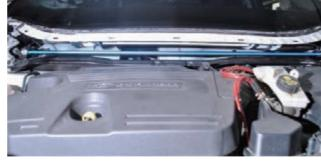
2. 拉桿安裝位置為隱藏式,在前擋風玻璃下方擋火牆位置
