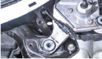
1. 須將兩刷桿拆下,及兩刷蓋板上層與下層拆下,再將支架安裝在避震器上座鎖點位置
